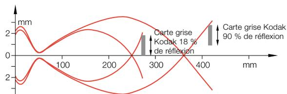
Distance de détection mesurée par démarrage latéral avec carte grise Kodak.
