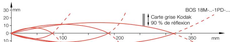
Distance de détection mesurée par démarrage latéral avec carte grise Kodak.
