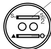
Commutateur permettant de réduire la portée de moitié. La portée se règle avec plus de précision. La résolution du potentiomètre 18 tours se trouve augmentée.
