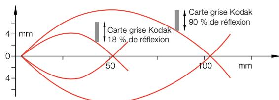
Distance de détection mesurée par démarrage latéral avec carte grise Kodak.
