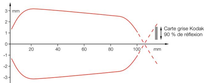
Distance de détection mesurée par démarrage latéral avec carte grise Kodak.
