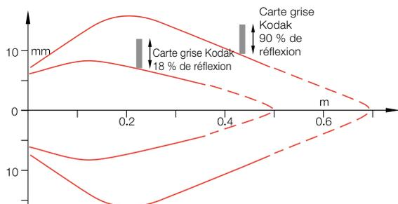
Distance de détection mesurée par démarrage latéral avec carte grise Kodak.
