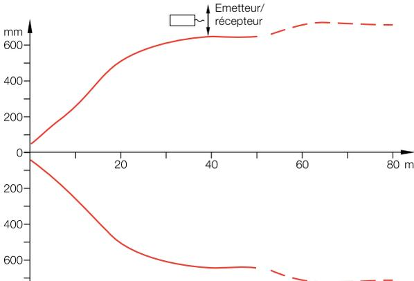
Dans le cas du barrage optique monodirectionnel, le décalage maximum possible est mesuré entre l'émetteur et le récepteur.
