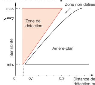
La "zone non définie" du détecteur optique BOS 25K-5-M25-... est la zone comprise entre la zone de détection et l'arrière-plan. La distance de détection se règle entre 50 mm et 250 mm au moyen d'une tige filetée sur la face supérieure de l'appareil. La zone non définie se modifie proportionnellement à la distance de détection.
