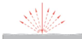
**Barrage optique à réflexion**
