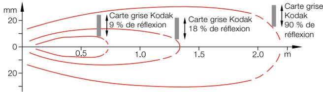
Distance de détection mesurée par démarrage latéral avec carte grise Kodak.
