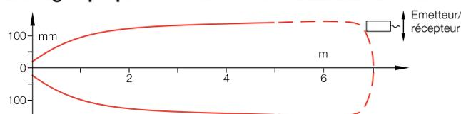
Dans le cas du barrage optique monodirectionnel, le décalage maximum possible est mesuré entre l'émetteur et le récepteur.
