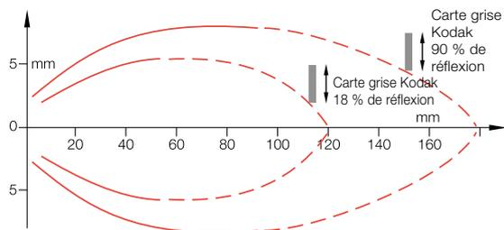
Distance de détection mesurée par démarrage latéral avec carte grise Kodak.
