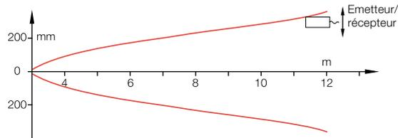
Dans le cas du barrage optique monodirectionnel, le décalage maximum possible est mesuré entre l'émetteur et le récepteur.
