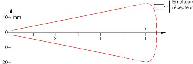
Dans le cas du barrage optique monodirectionnel, le décalage maximum possible est mesuré entre l'émetteur et le récepteur.
