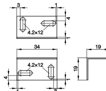
**Réflecteur BOS R-10 (est livré avec le barrage optique à réflexion)**
