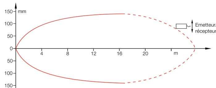
Dans le cas du barrage optique monodirectionnel, le décalage maximum possible est mesuré entre l'émetteur et le récepteur.
