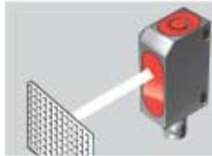
Orienter le capteur sur le réflecteur/le récepteur.
