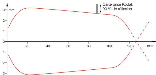
Distance de détection mesurée par démarrage latéral avec carte grise Kodak.
