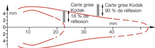
Distance de détection mesurée par démarrage latéral avec carte grise Kodak.
